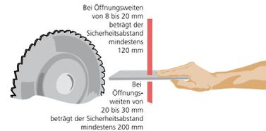
Beispiel: Beim Hineinreichen in und Hindurchreichen durch längliche Öffnungen mit parallelen Seiten beträgt der Sicherheitsabstand bei Öffnungsweiten über 4 bis 8 Millimeter (mm) mindestens 15 mm, bei Öffnungsweiten über 8 bis 20 mm mindestens 120 mm, bei Öffnungsweiten über 20 bis 30 mm mindestens 200 mm und bei Öffnungsweiten über 30 bis 135 mm mindestens 850 mm.
